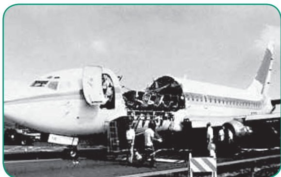
28 avril 1988 : Boeing 737-200 du vol 243 d'Aloha Airlines près de Maui (Hawaï) dont le revêtement et la structure du fuselage supérieur se sont arrachés en vol.
